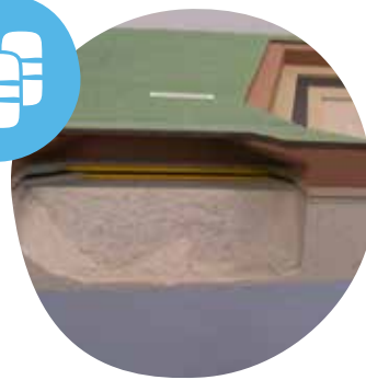
Chambre de collecte des eaux de drainage
